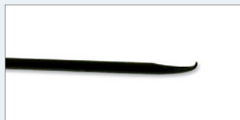
Uszkodzona końcówka igły
