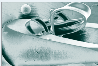
Odrywanie się fragmentów membrany silikonowej.
