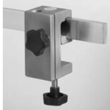
19799-04 Leichtmetall-Klemmsockel Spannweite 50 mm, für ein höhenverstellbares Stativ \varnothing 16 mm, für Schienen 25/35 x 8/10 und Röhre \varnothing 12 - 35 mm. Clamp socket made of light metal, holding width 50 mm, for height-adjustable stand \varnothing 16 mm, for rails 25/35 x 8/10 and tubes \varnothing 12 - 35 mm.
