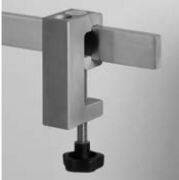
19799-03 Leichtmetall-Klemmsockel Spannweite 35 mm, für ein Schraubstativ mit \varnothing 16 mm/M10, für Schienen 25/35 x 8/10 und Röhre \varnothing 12 - 35 mm. Clamp socket made of light metal, holding width 35 mm, for screw stand \varnothing 16 mm/M10, for rails 25/35 x 8/10 and tubes \varnothing 12 - 35 mm.
