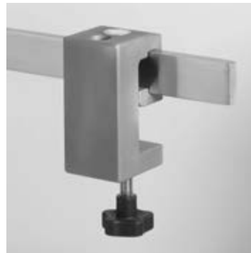
19799-06 Leichtmetall-Klemmsockel Spannweite 50 mm, für ein Schraubstativ mit \varnothing 16 mm/M10, für Schienen 25/35 x 8/10 und Röhre \varnothing 12 - 35 mm. Clamp socket made of light metal, holding width 50 mm, for screw stand \varnothing 16 mm/M10, for rails 25/35 x 8/10 and tubes \varnothing 12 - 35 mm.
